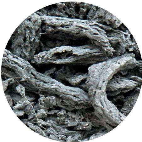
Boues traitées par le sécheur BIOCO®
