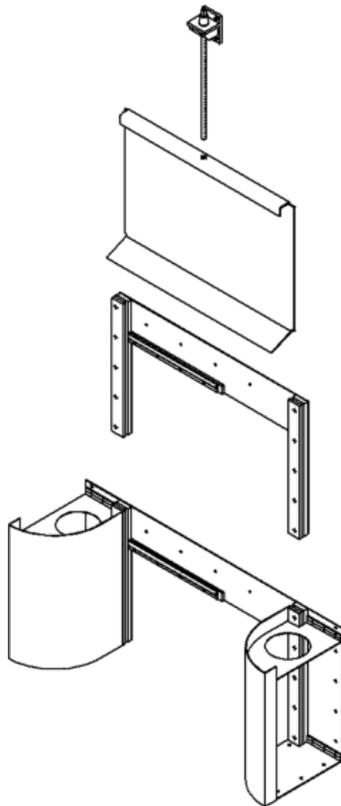
*Figure 2 : HYDROVEX® FluidHook avec tige filetée pour opération manuelle.*
