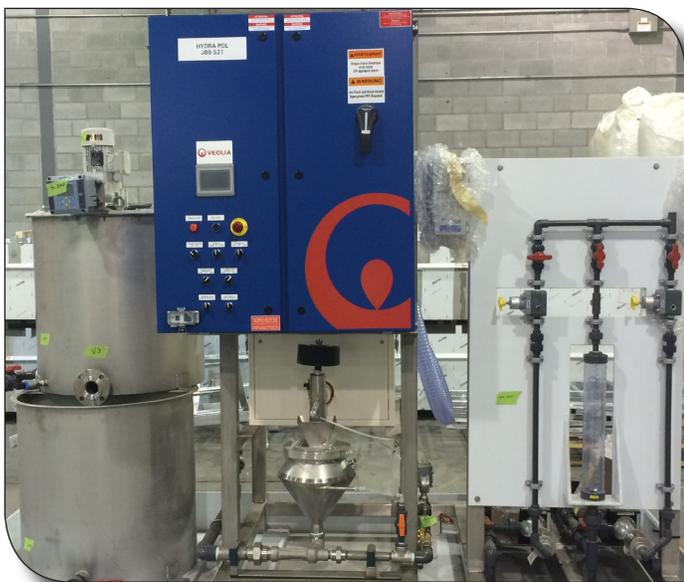
**Veolia Water Technologies Canada Inc.**, offre la gamme de produits HYDRA-POL. Les systèmes automatisés permettent d'obtenir une dissolution complète du polymère en poudre. Ces systèmes clés en main sont plus sécuritaires pour les opérateurs.
