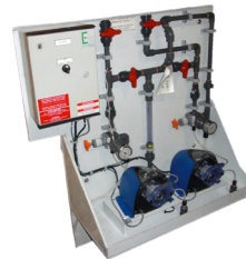
Skid de dosage
